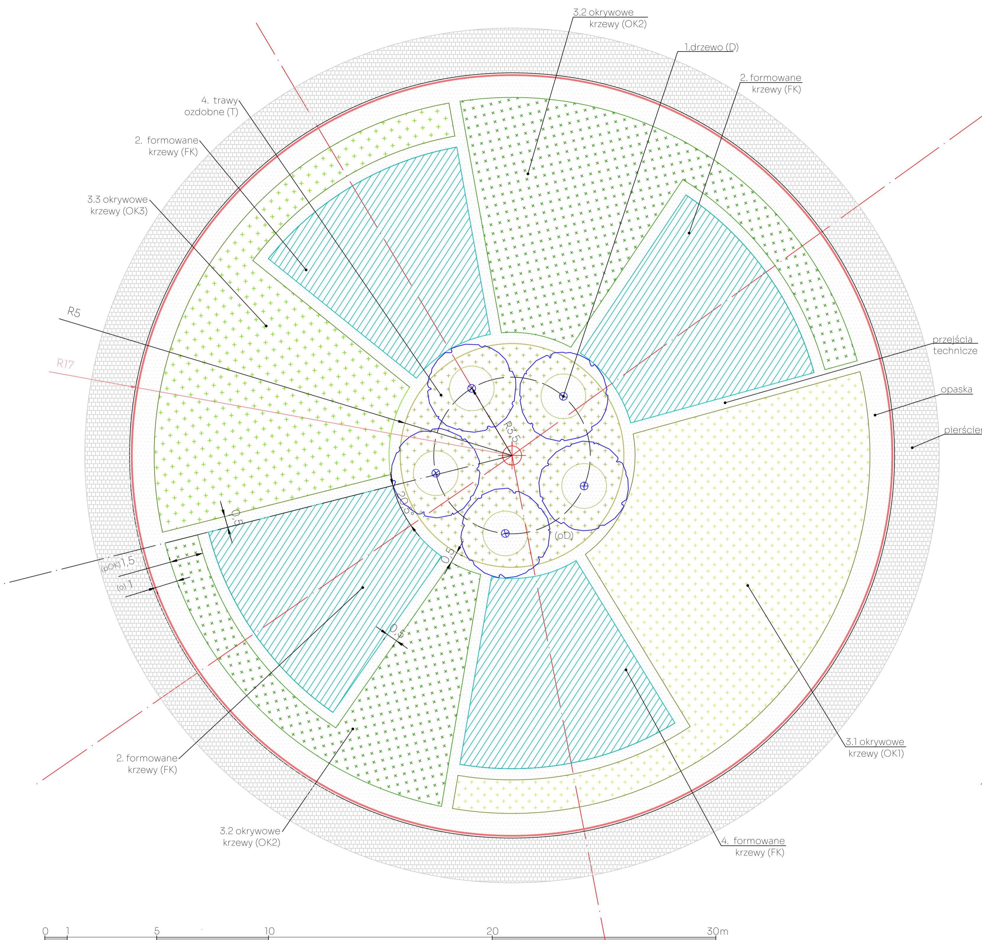
Rondo o najmniejszej średnicy wyspy środkowej \varnothing 28 m
